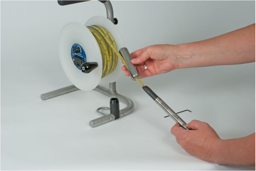
Figura 2-2 Deslizando la Pesa (Opcional) de la cinta
