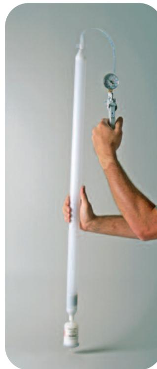
Filtración en línea utilizando la Geotech Hand Pump, bailer presurizado y dispos-a-filter™
