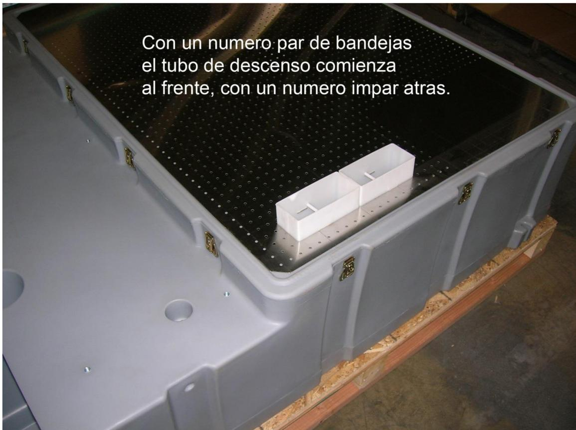
Figura 4-3 – Primer Placa Burbuja en el Colector
