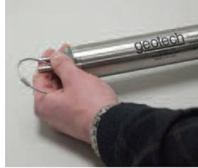
Coloque el montaje inferior de admisión (#51150067) atornillándolo en la parte inferior de la bomba. No debe haber ninguna separación entre la estructura exterior y las tapas inferior y superior.
