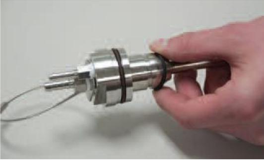
Deslice la vejiga (#21150054) en el tubo central y sobre el O-ring (#11150319) en el extremo superior del tubo central.
