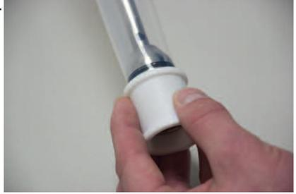
Remueva el anillo de compresión de PTFE superior (#21150042) y deslícelo hacia fuera por el extremo del tubo interno central (#21150091).
