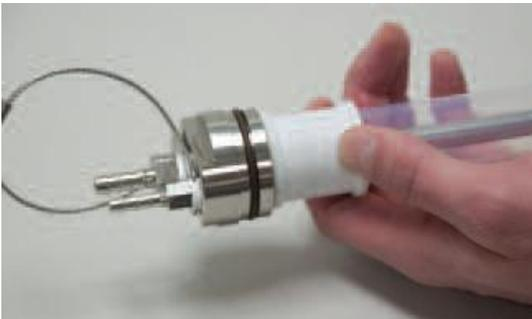
Con el extremo superior de la vejiga asegurado con el anillo de compresión de PTFE, deslice el segundo anillo de compresión sobre la vejiga hasta la mitad.
