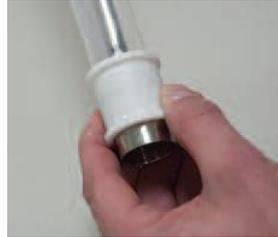
Coloque nuevamente la estructura externa (#21150041). Asegúrese que la estructura externa este sellada con la tapa superior.
