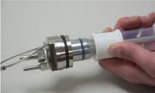
Deslice el anillo de compresión de PTFE (#11150042) sobre la vejiga y presione hacia abajo sobre la vejiga y el extremo superior del tubo central.
