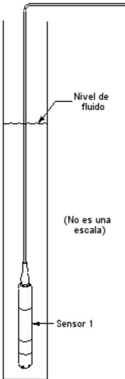
El Sensor 1 mide tanto el nivel de fluido como la presión atmosférica. Sin embargo cuando la presión atmosférica varía es insignificante para la medición total. Los requerimientos de la aplicación pueden variar. La compensación atmosférica puede ser requerida por los requerimientos del sistema.
